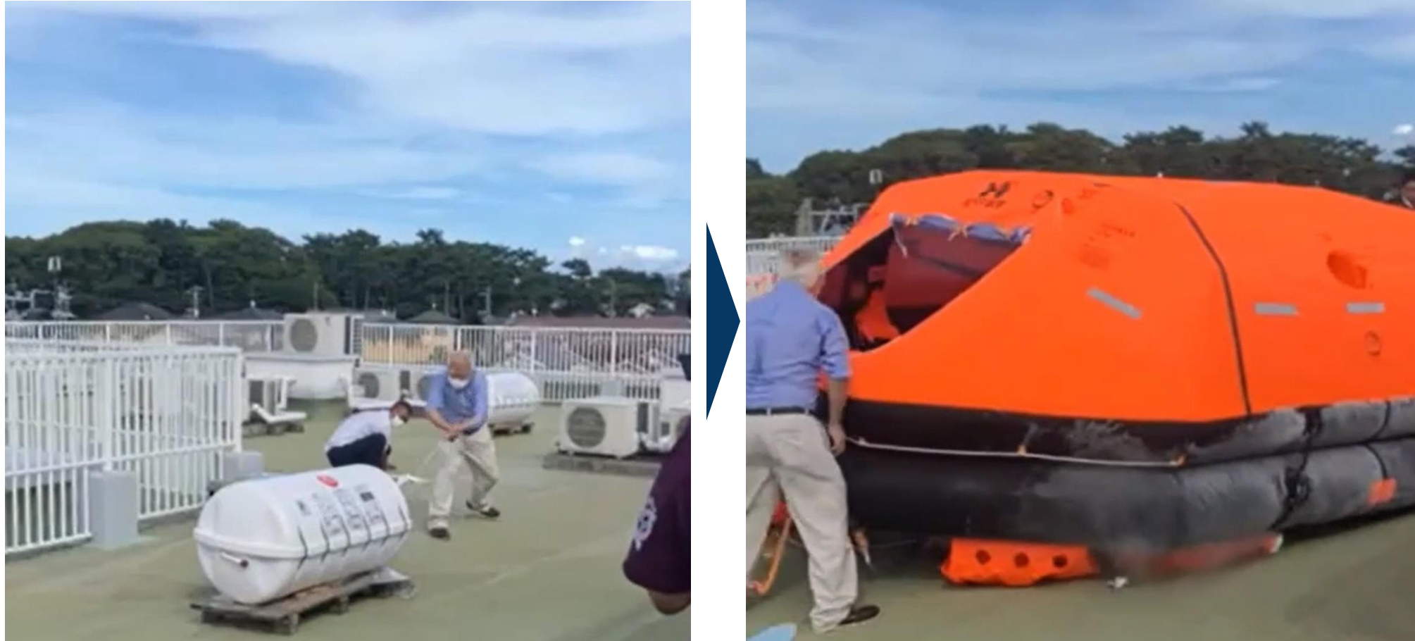
同施設での自動膨張の実演風景。1分以内に展開が完了する（出典 株式会社メテックス）
